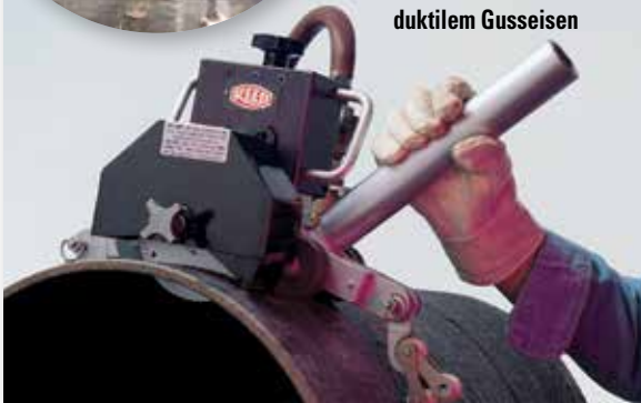
UPC636A auf Rohr aus duktilen Gusseisen
